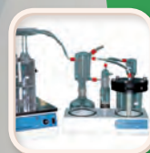
Lavador de gases
