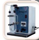
Medidor de volumen de gas
