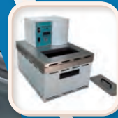
Baño recirculador con calentamiento
