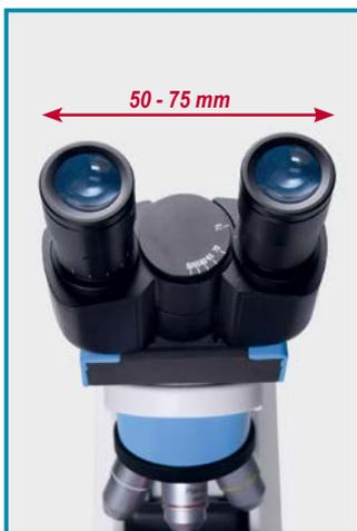
Dispone de un cabezal binocular giratorio de 360° inclinado a 30° con distancia interpupilar ajustable 50 mm - 75 mm.
