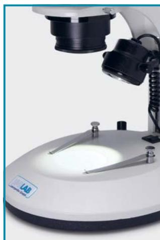
Dispone de una fuente de alimentación de 100 - 220 voltios de clasificación de entrada múltiple y fácilmente reemplazable, súper brillante y potente. **Iluminación LED desde arriba.**
