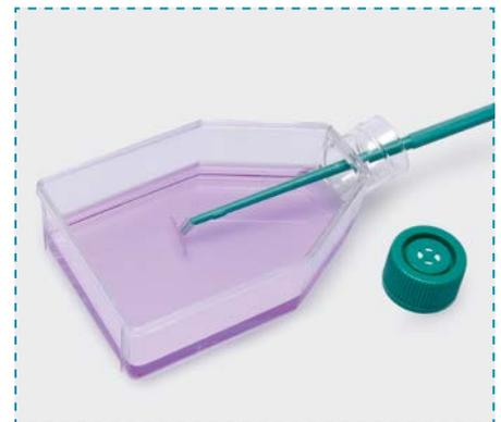
El diseño en ángulo del cuello del frasco permite un fácil acceso a cada esquina con un 100% de recuperación de células sin dejar ninguna esquina muerta.
