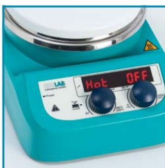
El display de advertencia de superficie caliente indica calor residual incluso si el equipo está apagado. El display LCD mostrará "CALIENTE" si la placa de calentamiento supera 50°C.
