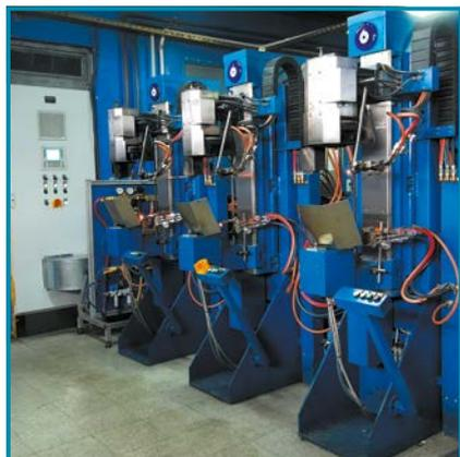
Para conectar las piezas de vidrio entre sí se utilizan máquinas automáticas de soldadura y fijación de última generación.
