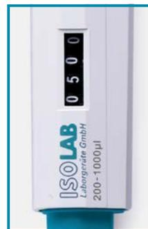
Garantiza un ajuste de volumen rápido y fácil con una sola mano. El display del volumen está siempre visible.
