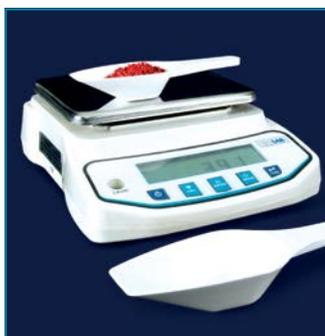
Debido a su construcción de fondo plano, estas cucharas pueden colocarse en posición horizontal sobre una superficie plana y también pueden usarse como una bandeja de pesaje.
