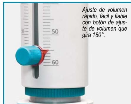
Ajuste de volumen rápido, fácil y fiable con botón de ajuste de volumen que gira 180°.
