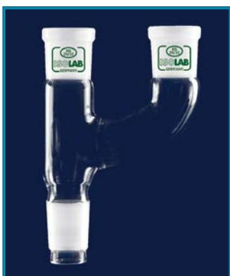
► Fabricado en vidrio de borosilicato resistente al calor y duradero y provisto de dos conectores hembra paralelos.
