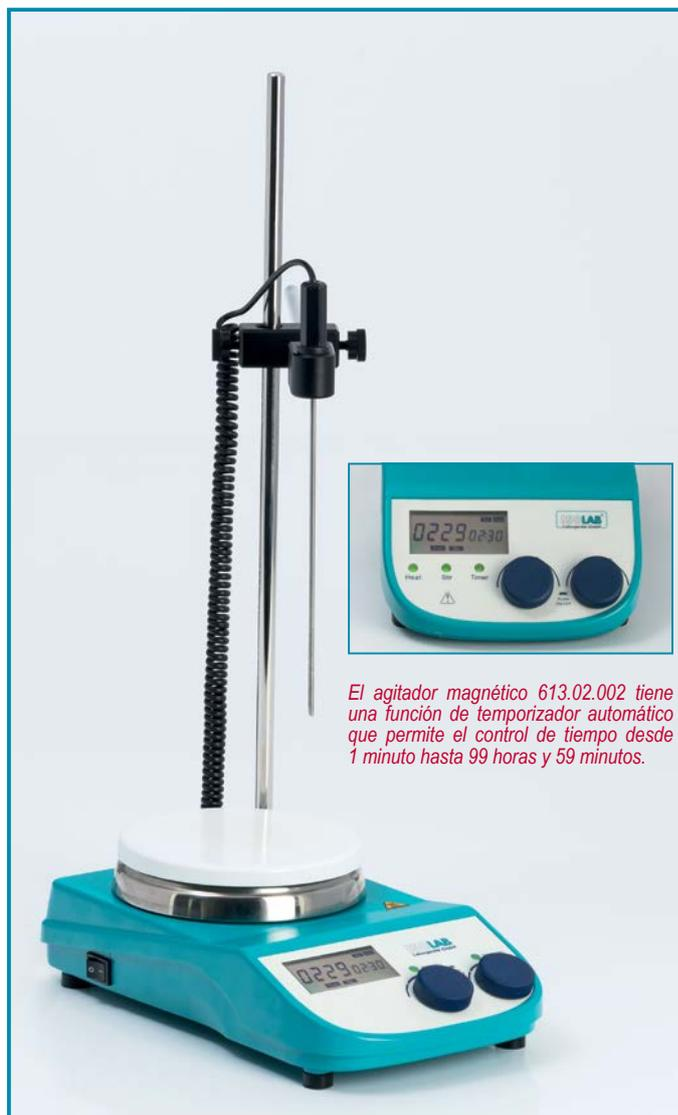
El agitador magnético 613.02.002 tiene una función de temporizador automático que permite el control de tiempo desde 1 minuto hasta 99 horas y 59 minutos.
