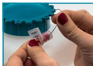
Introduzca el cable del sello a través de los agujeros de la tapa y el frasco. Luego inserte el cable en el orificio del sello como se muestra en la figura.
