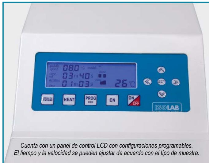
Cuenta con un panel de control LCD con configuraciones programables. El tiempo y la velocidad se pueden ajustar de acuerdo con el tipo de muestra.
