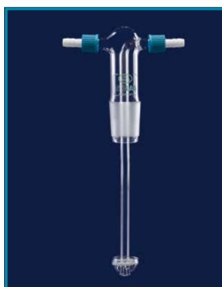
► Fabricado en vidrio de borosilicato resistente al calor y duradero con soporte de vidrio sinterizado.
