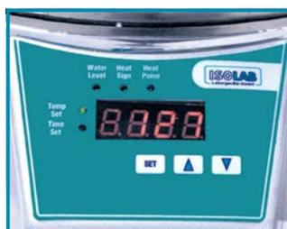
Cuenta con un temporizador electrónico de pantalla LED que permite el control del tiempo entre 1 y 99 minutos.
