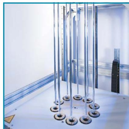
Los tubos de bureta se fabrican utilizando tecnología de vacío para mantener el diámetro de los tubos uniforme en toda su longitud.
