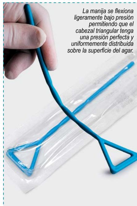
La manija se flexiona ligeramente bajo presión permitiendo que el cabezal triangular tenga una presión perfecta y uniformemente distribuida sobre la superficie del agar.
