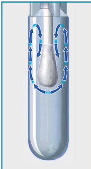
El diseño exclusivo con un estrechamiento "tipo venturi" evita la desintegración o la rotura de la columna de gel durante el transporte de la muestra.
