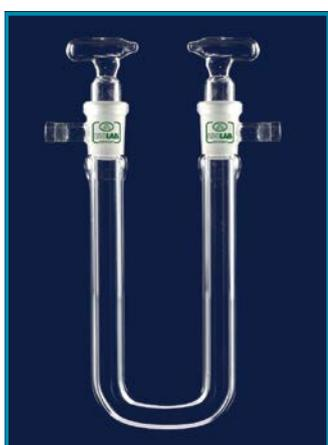
► Fabricado en vidrio de borosilicato resistente al calor y duradero según la norma ISO 12616, con forma en U y con una llave de paso.
