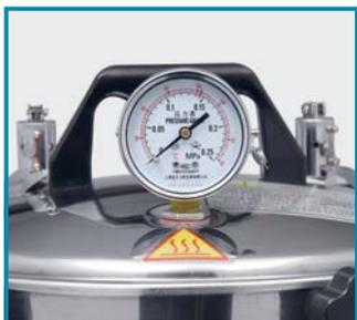
Los sistemas de "sobretemperatura" y "sobrepresión" aseguran el más alto nivel de seguridad durante el ciclo de funcionamiento.
