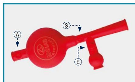
Para la evacuación del aire en el cuerpo, presione la bombilla y la válvula "A" simultáneamente. Para introducir el líquido con la velocidad deseada, presione la válvula "S". Para drenar el líquido parcial o completamente, presione la válvula "E".
