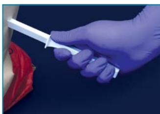
La cuchilla afilada penetra directamente en bolsas de papel o plástico para un proceso de muestreo óptimo y rápido.
