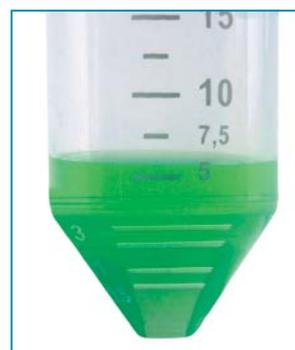
Las marcas de volumen precisas en el fondo del tubo muestran claramente el volumen de líquido contenido en el fondo.
