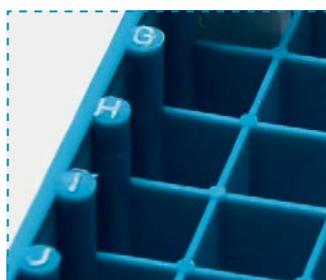
El índice alfanumérico permite una fácil identificación de las posiciones de los viales.
