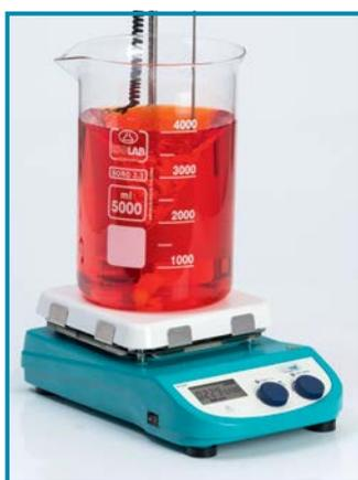
Motor de CC sin escobillas, exento de mantenimiento y a prueba de explosiones, con bajos niveles de ruido, permite la agitación de un volumen de hasta 20 l con un arranque suave y una detención rápida.
