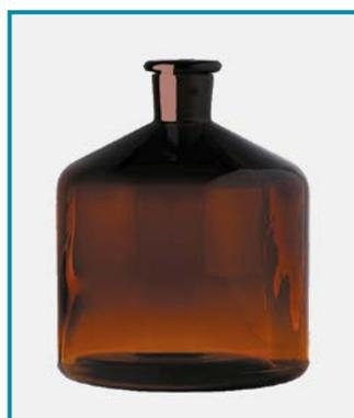
➤ Fabricado de vidrio grueso para ser utilizado con buretas automáticas. El cuello esmerilado con zócalo NS 29/32 se adapta perfectamente al cono de la bureta automática.
