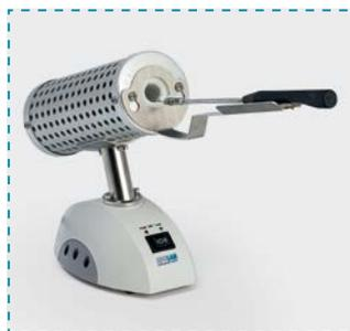
Un soporte de acero inoxidable proporciona una sujeción estable del mango del lazo durante la esterilización.
