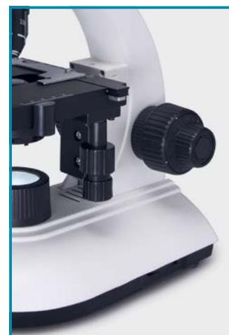
El ajuste grueso y fino se habilita con límite superior de seguridad con una división fina de 0,002 mm y un límite de movimiento de 20 mm. Cada rotación del botón de control permite una carrera gruesa de 42,4 mm y una carrera fina de 0,2 mm.
