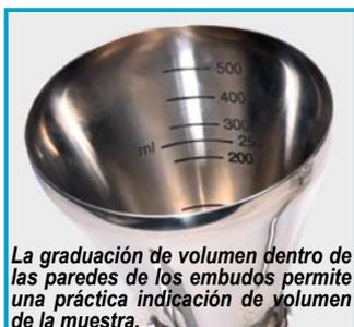
La graduación de volumen dentro de las paredes de los embudos permite una práctica indicación de volumen de la muestra.
