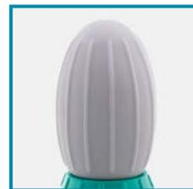
Antes de colocar la pipeta, comprima el fuelle de succión para la formación de vacío.
