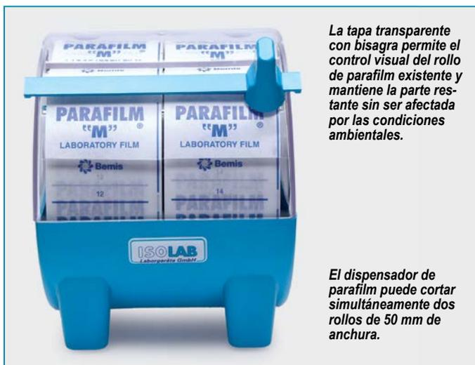
La tapa transparente con bisagra permite el control visual del rollo de parafilm existente y mantiene la parte restante sin ser afectada por las condiciones ambientales.
