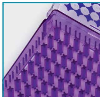
Las varillas de soporte de diseño tipo "erizo" en disposición cruzada permiten alinear los tubos en su posición de forma uniforme y firme.
