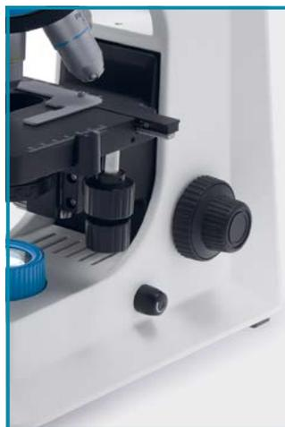
El ajuste grueso y fino se habilita con límite superior de seguridad con una división fina de 0,002 mm y un límite de movimiento máximo de 20 mm. Cada rotación del botón de control permite una carrera gruesa de 37,7 mm y una carrera fina de 0,2 mm.
