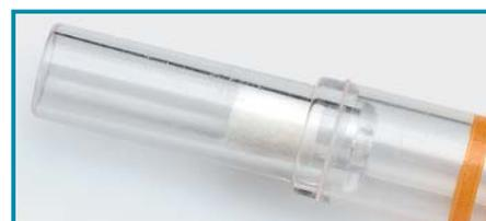
El tapón del filtro en la boquilla de la pipeta evita los efectos exteriores y minimiza la contaminación.
