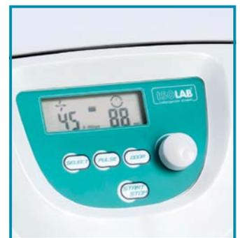
La pantalla LCD grande y fácil de usar permite una fácil identificación de los parámetros y muestra todas las informaciones, incluido el tiempo acumulado de operación y los últimos parámetros de funcionamiento.
