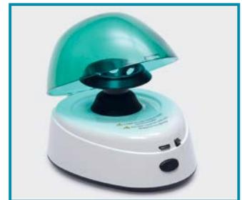
**Fácil de detener:** Abra la tapa, el freno electrónico detiene el rotor inmediatamente.
