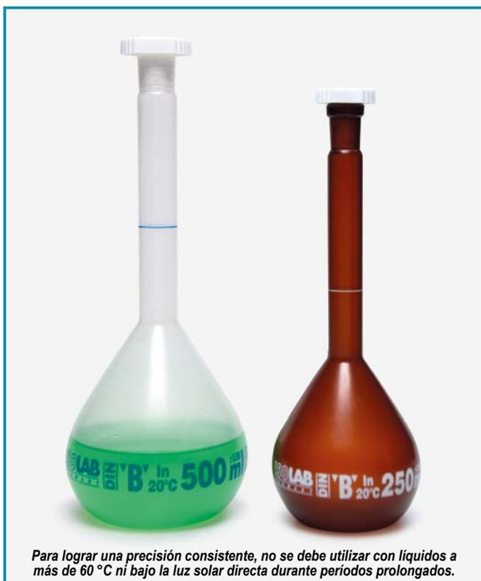
Para lograr una precisión consistente, no se debe utilizar con líquidos a más de 60 °C ni bajo la luz solar directa durante periodos prolongados.
