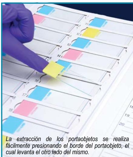
La extracción de los portaobjetos se realiza fácilmente presionando el borde del portaobjeto, el cual levanta el otro lado del mismo.
