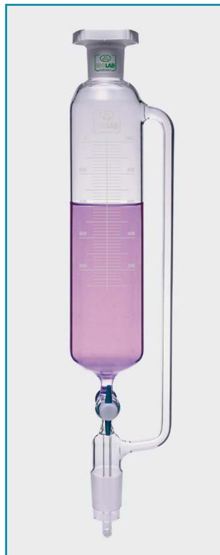
**EMBUDOS - "goteo" - "cilíndrico"
