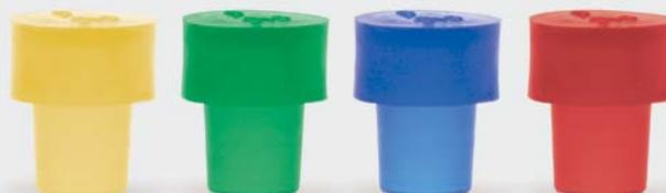
➤ Fabricadas de EVA con un ajuste perfecto para tubos de RMN de 5 mm.
