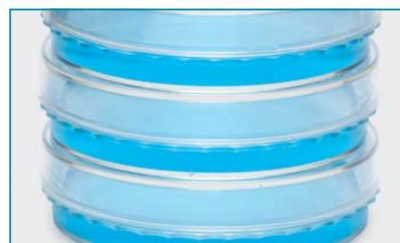
El anillo de apilamiento en la tapa y en la parte de la base correspondiente garantiza una opción de apilamiento seguro.
