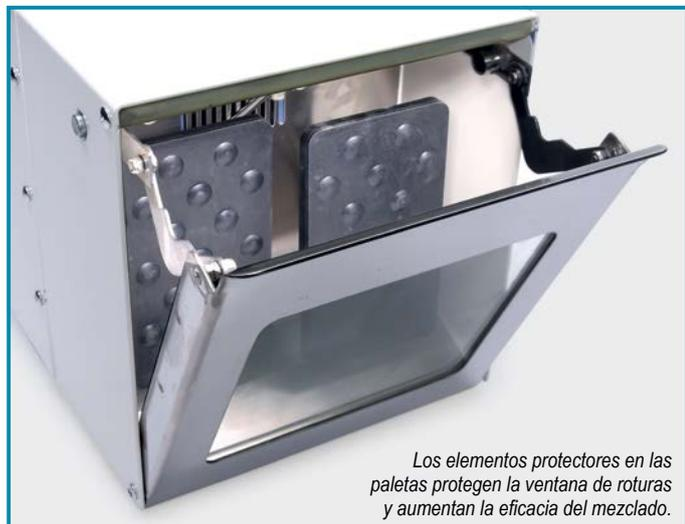
Los elementos protectores en las paletas protegen la ventana de roturas y aumentan la eficacia del mezclador.
