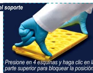
Presione en 4 esquinas y haga clic en la parte superior para bloquear la posición.
