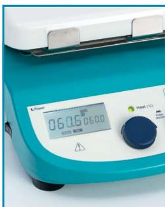
Gran panel LCD para la visualización simultánea de la temperatura nominal y real y de la velocidad nominal y real.
