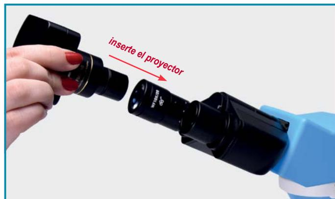
Muy fácil de usar; primero retire el ocular del tubo del mismo. Después atornille el proyector de imágenes al ocular e inserte el ocular en el tubo del mismo.
