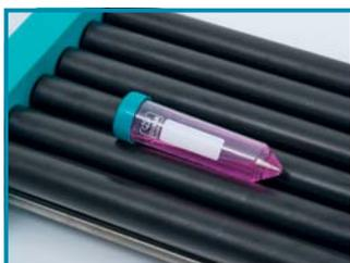
Los rodillos de goma con silicona aseguran una sujeción perfecta del tubo y garantizan una rodadura efectiva.
