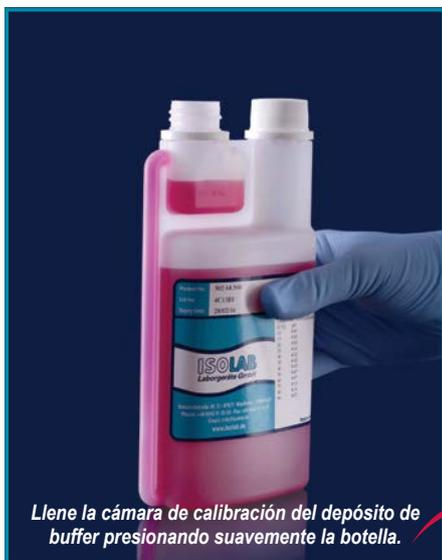
Llene la cámara de calibración del depósito de buffer presionando suavemente la botella.
