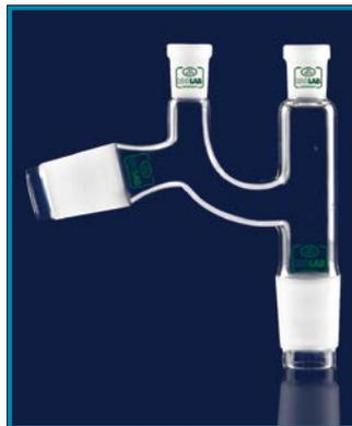
► Fabricado en vidrio de borosilicato resistente al calor y duradero según la norma ISO 12594, provisto con un cono en ángulo de 75° hacia abajo.
