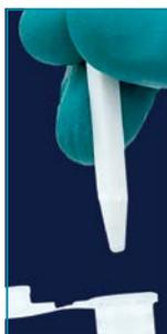
Los dos extremos idénticos con punta redonda encajan perfectamente en el interior de microtubos de 1,5 y 2,0 ml.
