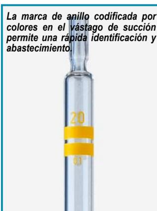
La marca de anillo codificada por colores en el vástago de succión permite una rápida identificación y abastecimiento.
