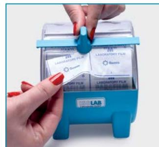
El parafilm se corta con un movimiento de la cuchilla de lado a lado.
