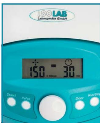
La pantalla LCD grande y fácil de usar permite ajustar y leer fácilmente los parámetros funcionales. Tanto RPM como RCF se pueden ajustar y visualizar.
