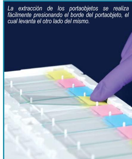
La extracción de los portaobjetos se realiza fácilmente presionando el borde del portaobjeto, el cual levanta el otro lado del mismo.
