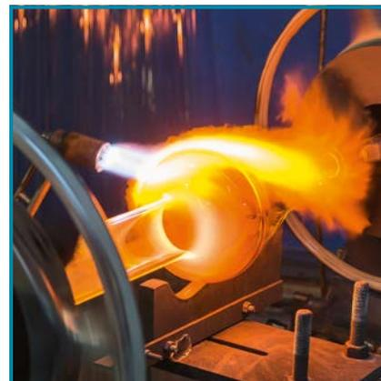
Los tubos de vidrio son soplados por sopladores altamente cualificados para asegurar un espesor uniforme de la pared y dimensiones exactas de acuerdo con las normas DIN.
