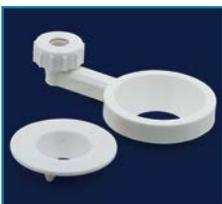
El soporte de embudo sin hendidura consiste de 2 partes.
