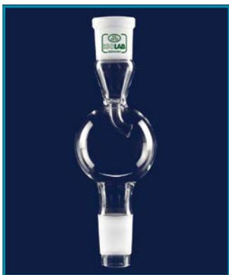
► Fabricado en vidrio de borosilicato resistente al calor y duradero para separación de gotas. Recomendado para ser colocado directamente sobre la parte superior de los frascos de destilación.
