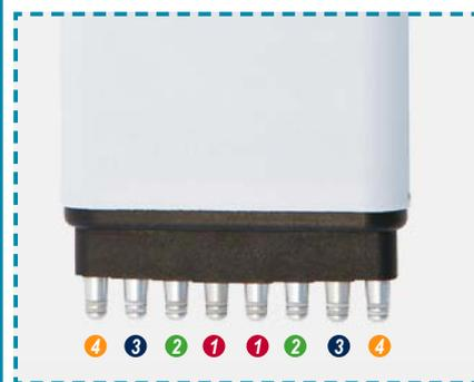
Las puntas de pipeta se expulsan una después de la otra. Primero caen dos puntas en las posiciones 1, después caen dos puntas en las posiciones 2. Después le siguen las puntas en las posiciones 3 y 4.
