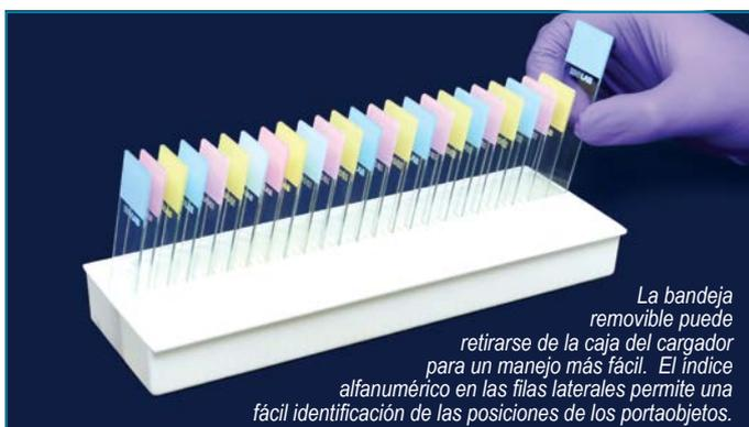
La bandeja removible puede retirarse de la caja del cargador para un manejo más fácil. El índice alfanumérico en las filas laterales permite una fácil identificación de las posiciones de los portaobjetos.
