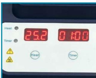
El temporizador automático permite un funcionamiento controlado por tiempo entre 1 minuto hasta 99 horas y 59 minutos.
