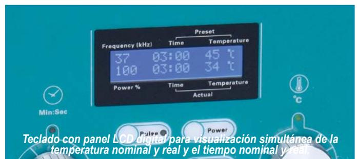
Teclado con panel LCD digital para visualización simultánea de la temperatura nominal y real y el tiempo nominal y real.
