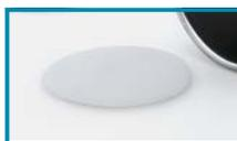
La almohadilla de silicona actúa como un amortiguador e impide el riesgo de rotura de las pipetas.
